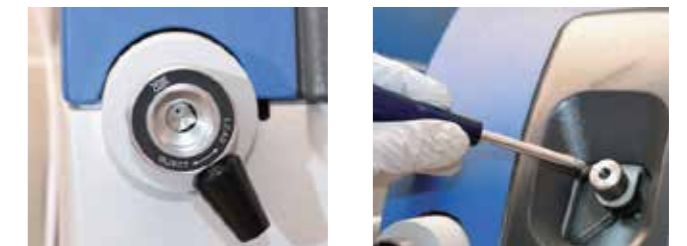
図3. シリンジダイレクトインジェクションポートバルブ(左/標準)。固体試料を直接打てるASAPプローブ(右/オプション)。
