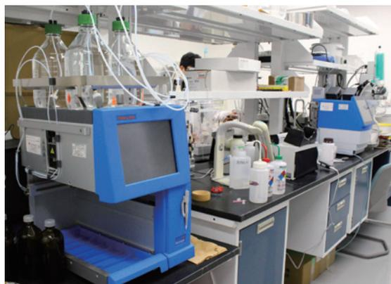
有機合成で実際にお使いいただいているフラッシュ自動精製装置Isolera(左)とマイクロウェーブ合成装置Initiator+ Eight(右)
