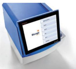
シングルモード照射で、パワフルかつ精密に温度を制御します。高温高圧反応による高効率な合成をサポートします。
