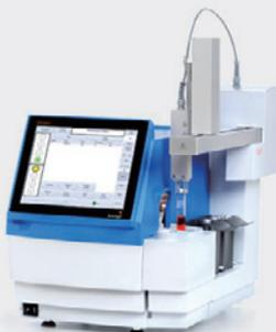
オートサンプラー付き、最大8検体までの連続合成ができるマイクロウェーブ合成装置です。400Wのシングルモード照射で、パワフルかつ精密に温度を制御します。操作はタッチパネルスクリーンを採用し、PCなどの余計なスペースを必要としません。操作性・安定性に優れたマイクロウェーブ合成装置として多くの研究機関で活躍しています。
