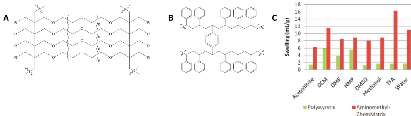
図 1: レジンの分子構造の対比 A) ポリエチレングリコールポリマー組成の ChemMatrix® レジン B) 一般的なポリスチレンポリマー組成の Merrifield 型レジン C) 固相ペプチド合成に一般的に使用される溶媒におけるレジンの膨潤性の比較。
