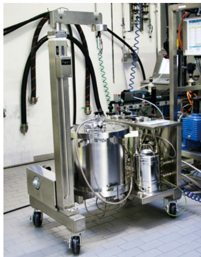
図2b. Biotage® Flash 400システムは、CordenPharma Switzerlandでの効率的な精製クロマトグラフィーのためのカスタムプロセスワークフローに組み込まれています。
