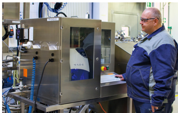
図3. CordenPharma Switzerland では、化合物検出にオンラインUVとELSDを使用している。
