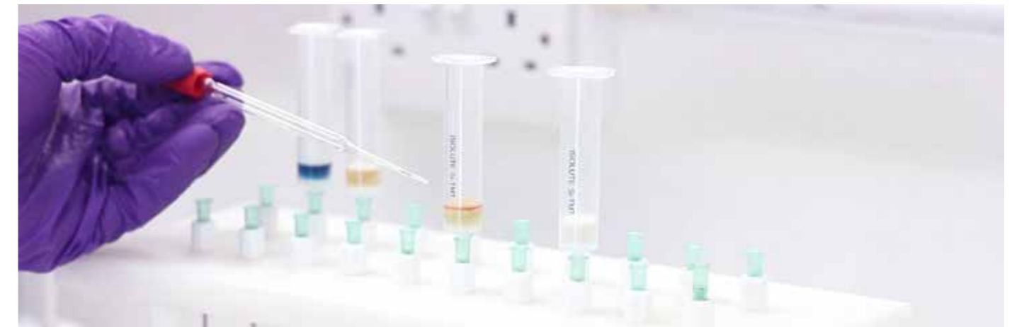
2. 目的物が通過すると、パラジウムが効率的に保持されます。
