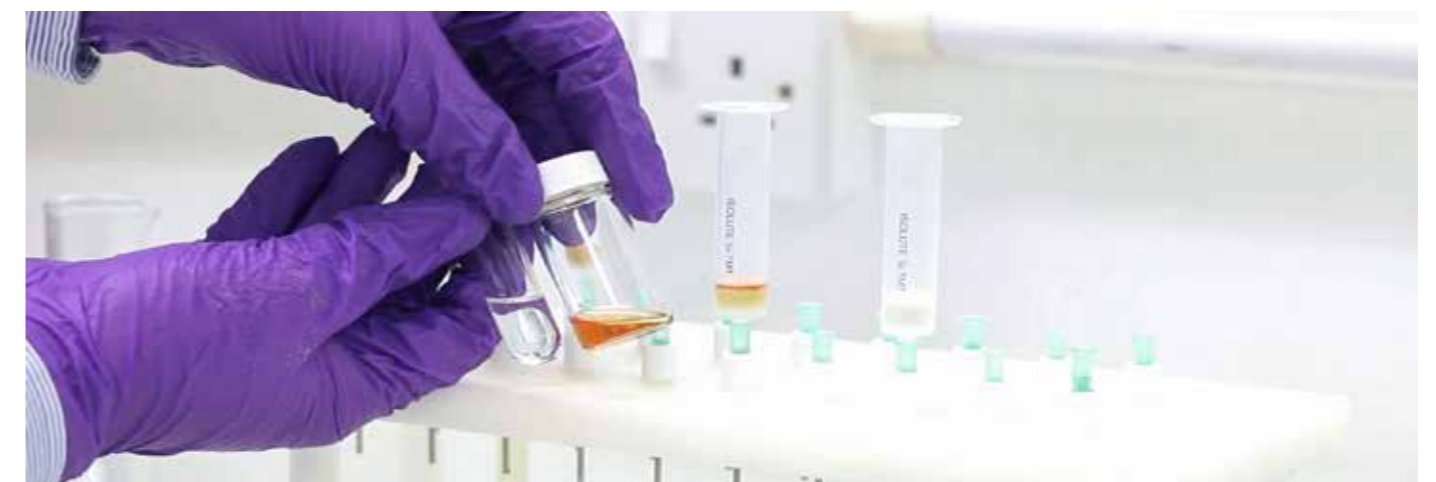
3. 左側が透明な目的物抽出液、右側が元のパラジウム触媒です。
