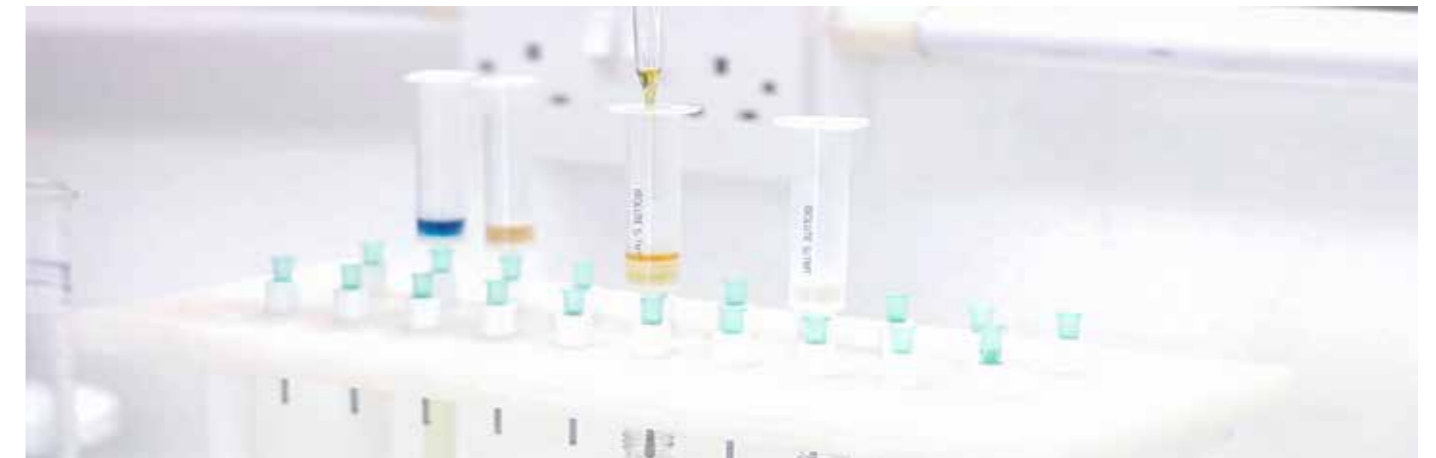
1. 粗Pd/母液 (Pd 1000 ppm) をSi-TMTに加えります。
