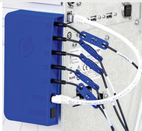
Hubを装置側面に取り付け
