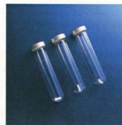
Figur 4. Reaktionskolber til anvendelse ved mikrobølgebaseret kemi. Kolberne lukkes ved hjælp af crimp caps.
