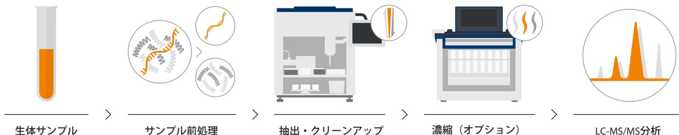
図3. 前処理、抽出、クリーンアップ、蒸発の各ステップを統合した、バイオ分析サンプル調製のための Biotage® Oligo SPE エンドツーエンドのワークフロー。
