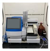
検討段階では他社製品のペプチド合成装置も試しましたが、最終的にAlstraを選びました。一番の決め手は、ペプチドを高い純度で合成できることです。他社製品で合成速度が速いものもありましたが、合成段階よりも精製が律速になるため、合成の速さよりも精製を短縮できる質の高さを優先しました。ある程度のスケールで非天然アミノ酸は合成できますが、出発物質として貴重なのでロスしたくないという思いもあります。Alstraの価格もリーズナブルでした。
