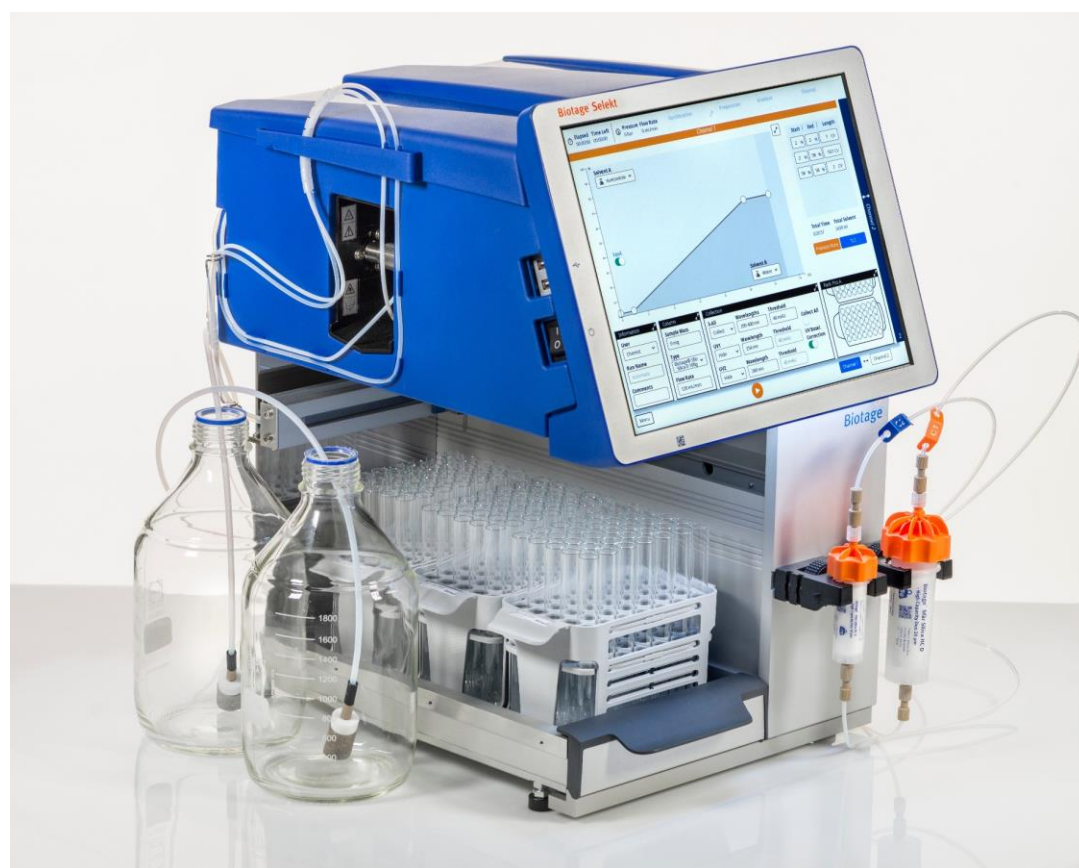
図 5. UV-VIS検出器を搭載したBiotage® Selekt
