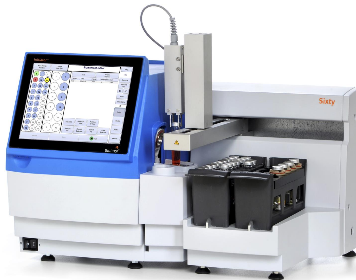
図3. マイクロウェーブ合成装置Biotage® Initiator+ とRobot 60
