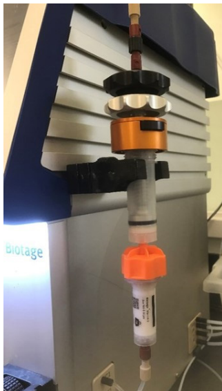
図4. 外部ドライローディングは、クルードと固体支持メディアを混ぜて乾燥させ、一次精製カラムの上部に取り付けられた別のカラムに詰め込んで使用されます。
