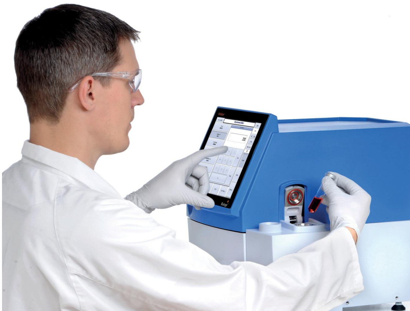
図 2. Biotage® Initiator+ は、ラボスケールのマイクロウェーブを利用した有機合成のための標準的なツールです。
