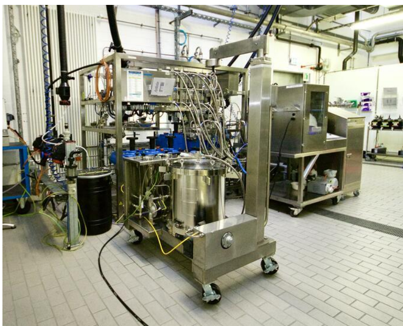
図 2. Biotage® Flash 400 システムは、CordenPharma Switzerland の効率的な精製クロマトグラフィーのためのカスタムプロセスワークフローに組み込まれました。
