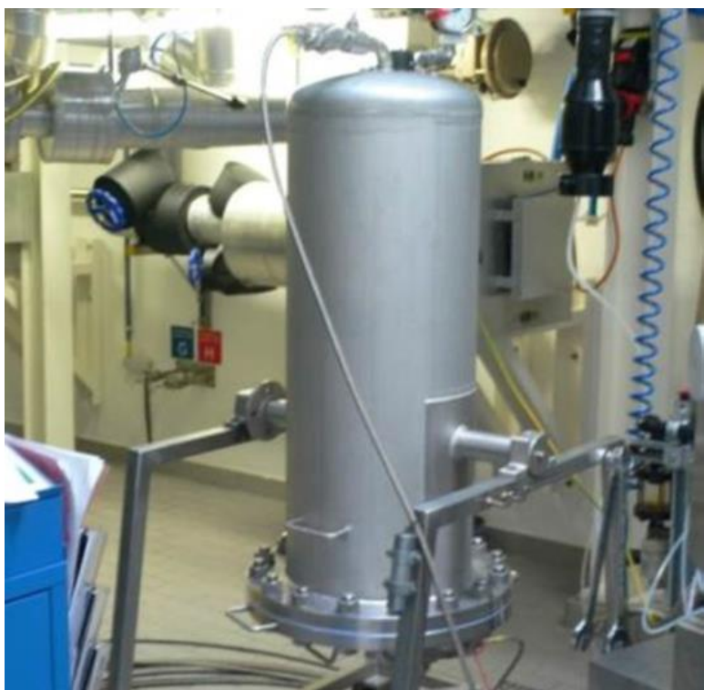
図 1. (従来のプロセス) -精製クロマトグラフィー用のフィルターを再利用。
