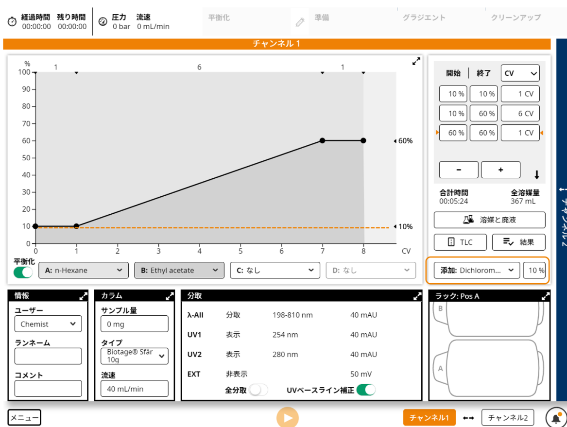
図9：Biotage® Selekt の操作画面：ヘキサン/酢酸エチルで10%-60%のグラジエント条件、バックグラウンドでジクロロメタンを10%流し続ける設定。 ※オレンジ色の点線、囲みは筆者が追加したもの
